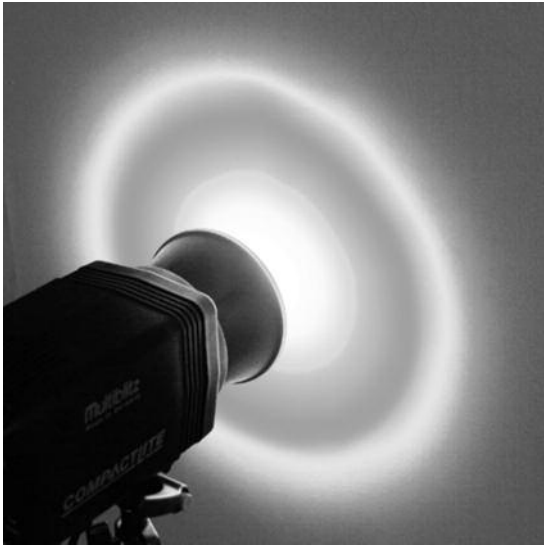
Cônes d'ombres et de lumières créés par un flash. Les cercles concentriques montrent la forme torique de l'ampoule.
