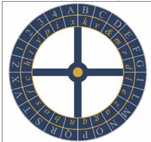
Le cadran d'Alberti fait correspondre les lettres de A à Z (sauf H, J, K, U, V, Y) plus les nombres de 1 à 4 à des symboles dans le désordre.
